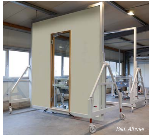
Abb. 13 Zur Prüfung der Dauerfunktion einer Tür wird diese in eine Prüfvorrichtung eingebaut und einer dauerhaften Belastung ausgesetzt. Innentüren müssen 200.000 Prüfzyklen ohne Beanstandung überstehen.
