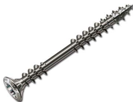
Abb. D12.10 Fassadenschraube aus Edelstahl mit Linsensenkkopf, Teilgewinde und Torxantieb, geeignet sowohl für die sichtbare als auch die nicht sichtbare Verschraubung bei Boden-Deckel-Schalung. Die selbstschneidende Spitze verhindert die Rissbildung, Fräsrippen ermöglichen das leichte und vollständige Versenken der Schrauben.
