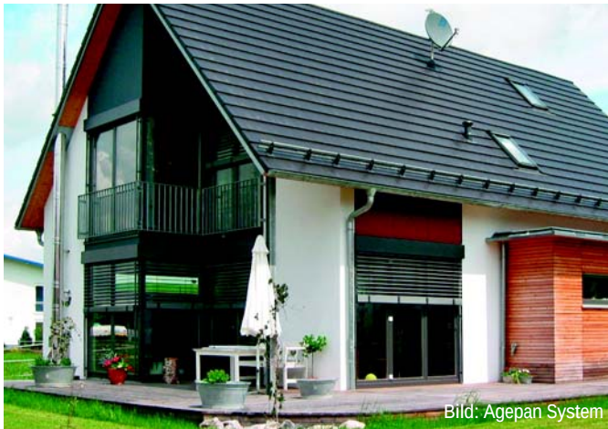
Abb. C14.14 Raffstore mit schwenkbaren Lamellen. Damit ist auch bei guter Verschattung ein Außenbezug noch möglich.
