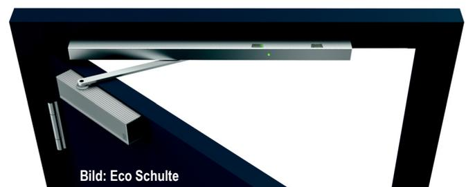
Abb. A5.17 Elektromechanische Feststellanlage mit integriertem Rauchmelder. Für die Montage sind Herstelleranleitung und Richtlinie des DIBt zu beachten.
