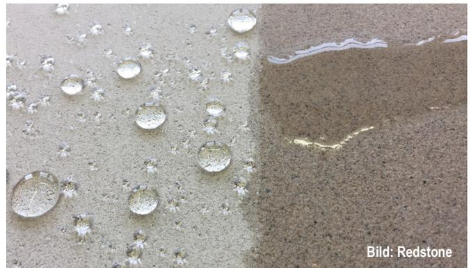
Abb. B3.12 Mit Hydrophobierungen der Wandaußenseiten können u. U. Innendämmungen ermöglicht werden. Vertraglich sind die Kontroll- und Wartungsintervalle zu klären (evtl. Wartungsvertrag).
