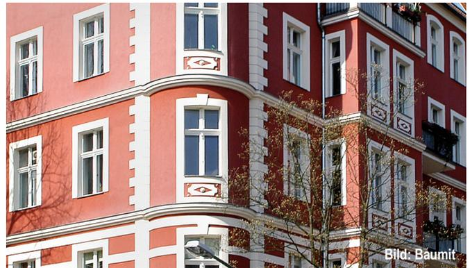
Abb. B3.11 Fassadenanstriche können erheblich zum Schlagregenschutz beitragen. Trotzdem dringt Feuchte durch Risse und bei Anschlüssen ein, die dann über die Fläche wieder austrocknen muss.
