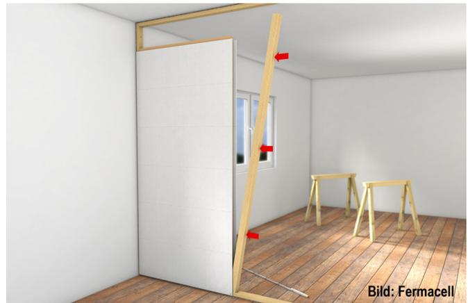
Abb. A2.7 Diese Trennwand wird nachträglich eingebaut. Alle seitlichen Bauteile gehen durch, ein guter Schallschutz kann nicht erreicht werden.
