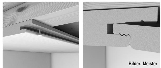
Abb. A4.9 Verschraubung von Deckenpaneelen mit Traglatten.
